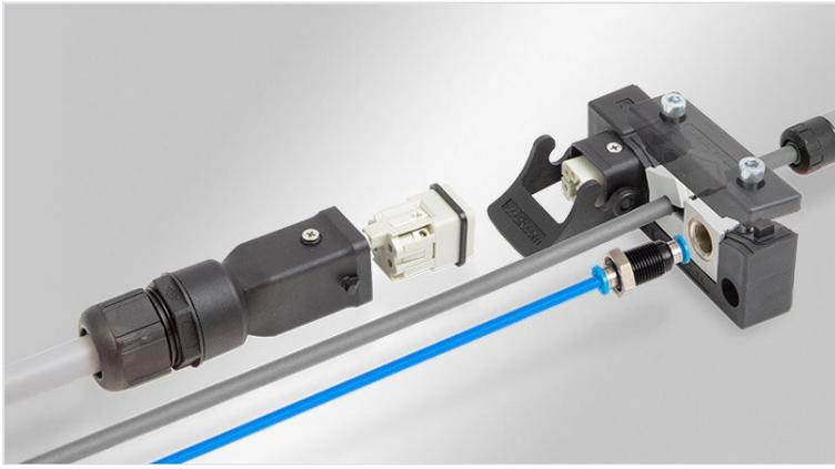
Le système d'interface modulaire (MIS) est un passer-câble divisible pour câbles avec et sans connecteurs en combinaison avec des connecteurs industriels 3A ou 4A. Un connecteur industriel de taille 3A ou 4A peut être enfiché directement sur le cadre. Les câbles d'un diamètre de 1 à 15 mm peuvent être acheminés, étanchéifiés et maintenus conformément à la norme EN 62444.
